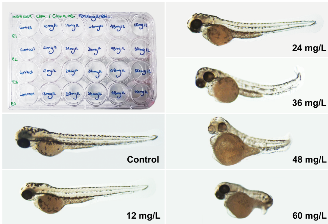
Figura 6. Ensayo de teratogenicidad usando un contaminante ambiental. Entre 5 y 10 embriones de 4 hrs post fertilización son depositados en cada pocillo de una placa de microtitulación. En un ensayo cuadruplicado se observa una respuesta consistente y progresiva al incremento en la concentración del contaminante. El efecto teratogénico consiste en un retraso del desarrollo, falla en la elongación, edema cardíaco, entre otros. Fuente: Galarza-Pichucho, Arévalo Cuaical, Ruano-Rivadeneira, Daniela Zurita-Paredes y Andrés Romero-Carvajal. Los autores de este artículo.
