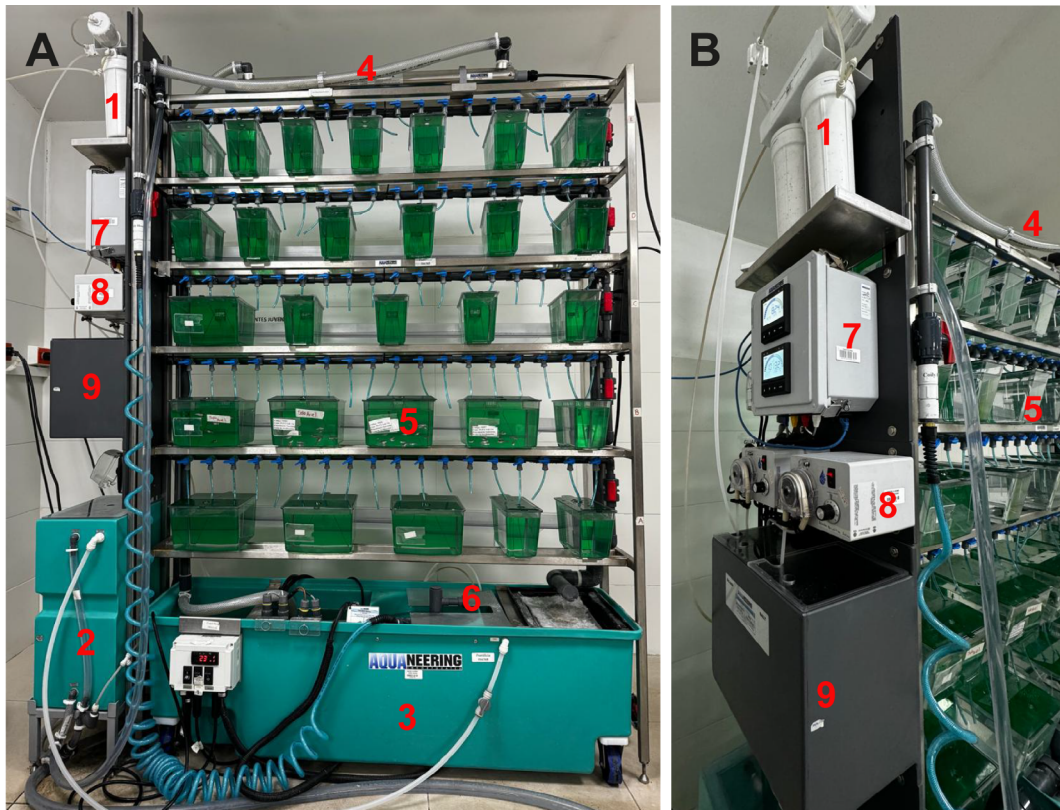
Figura 3. Sistema semiautomático de cría para peces cebra. A. Vista frontal. B. Vista Lateral. 1. Sistema de prefiltrado y ósmosis reversa para el agua de llave. 2. Sumidero para agua filtrada. 3. Sumidero principal para recirculación 4. Lámpara UV para esterilizar el agua recirculada. El agua esterilizada es repartida a cada uno de los tanques de cría (5) y el exceso de agua se derrama al sumidero principal. 6. filtro biológico. 7. Caja de monitoreo de pH y conductividad. 8. Bombas para compensación automática de pH y conductividad usando soluciones concentradas de \text{HCO}_3^- o sal de mar artificial almacenados en (9). Las bombas son activadas por la caja de monitoreo. Fuente: Galarza-Pichucho, Arévalo Cuaical, Ruano-Rivadeneira, Daniela Zurita-Paredes y Andrés Romero-Carvajal. Los autores de este artículo.
